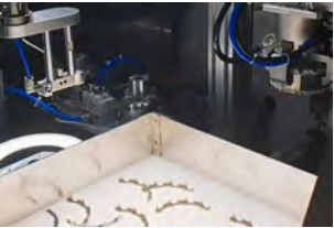
电机骨架柔性组装
